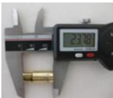
A parte cilíndrica do atomizador tem comprimento total de 15,75 +/- 0,25mm.
