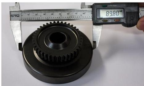
**5.3.9 Diâmetro interior do tambor.** A medição deve ser feita no meio (na área de contato entre a campana e a sapata). O valor **máximo** do diâmetro interior é de **84,90 mm**
