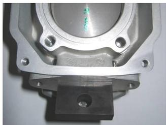
**4.6.2.** A modificação da junta (ref 250231) entre o cilindro e a base da válvula de exaustão não é permitida.
