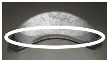
**4.5.6** O flange para a saída do escape pode apresentar finalização bruta (da fundição) ou usinada. A parte usinada pode ser lisa ou apresentar uma elevação circular para a vedação da junta.
