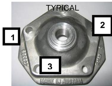
As alturas da câmara de combustão têm que ser de 28,80 mm com uma tolerância de +/- 0,2 mm (H).
