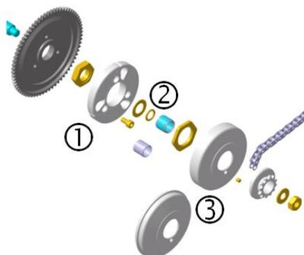
**5.3.1** Todos os motores deverão usar a gaiola 15x19x17 (indicado nas figuras acima NA COR AZUL) ou a bucha de nylon ROTAX quando utilizado o pinhão de 11 dentes. Em ambos os casos deve-se utilizar o o-ring 12x2,5, original Rotax. O piloto deve certificar-se de que o o-ring não esteja tão desgastado a ponto de permitir a entrada de óleo ou graxa dentro da campana. A arruela interna da embreagem deve ser a original Rotax.
