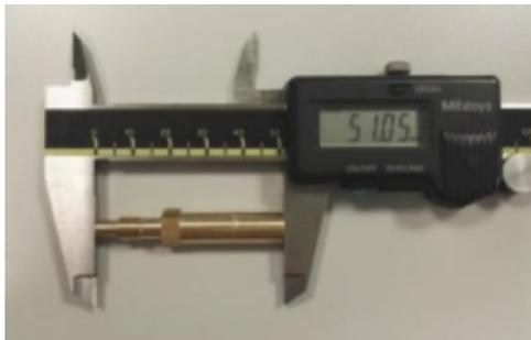
**b)** O comprimento da seção inferior é de 33,00 +/- 0,45mm
