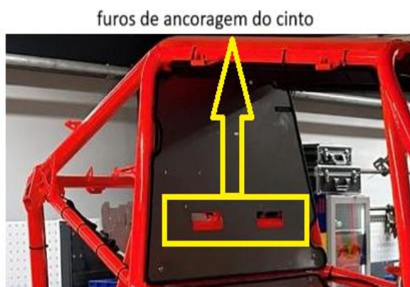
Imagem 2 – furos para ancoragem do cinto de segurança.
