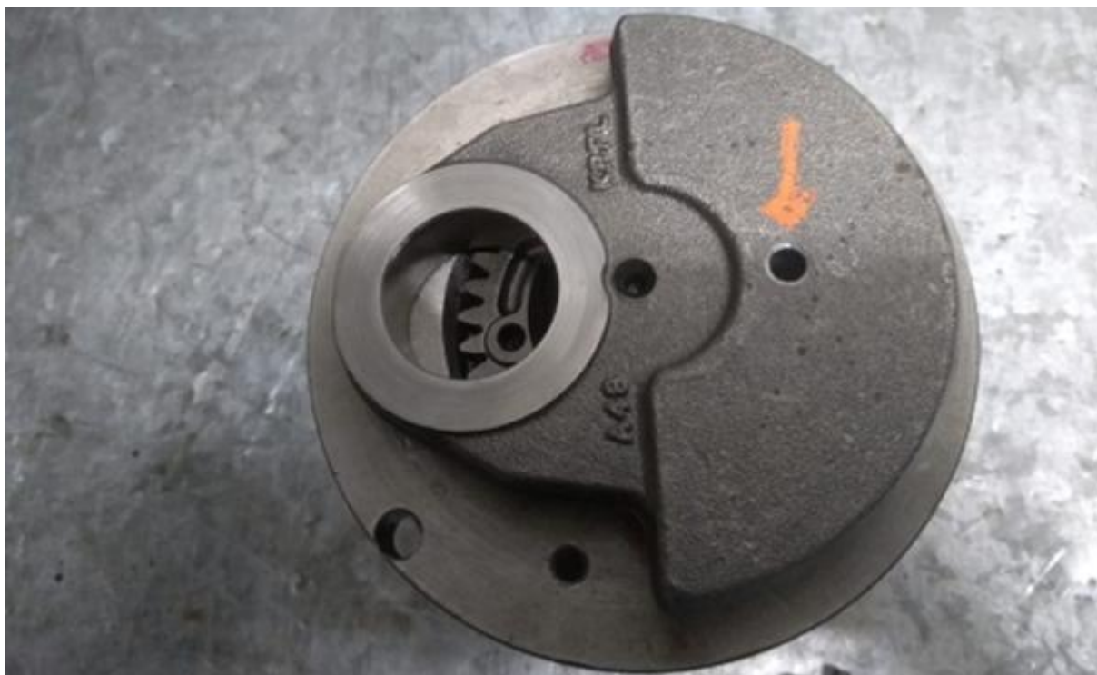
Imagem 6 - detalhe do furo na bolacha do virabrequim
