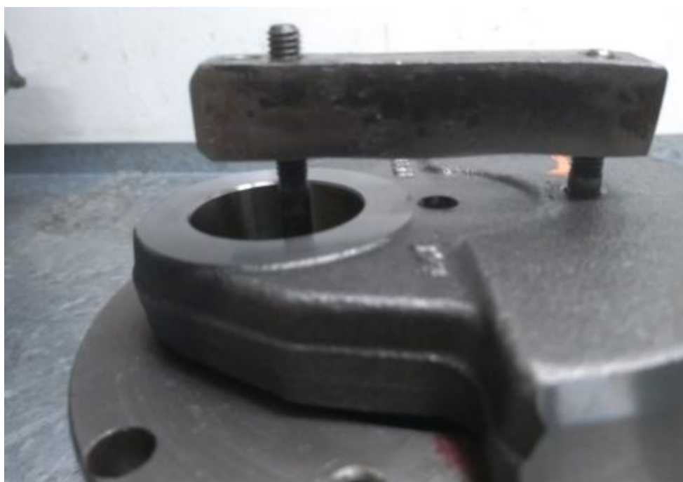
Imagem 8 – detalhe do saque da engrenagem com auxílio do furo e da ferramenta
