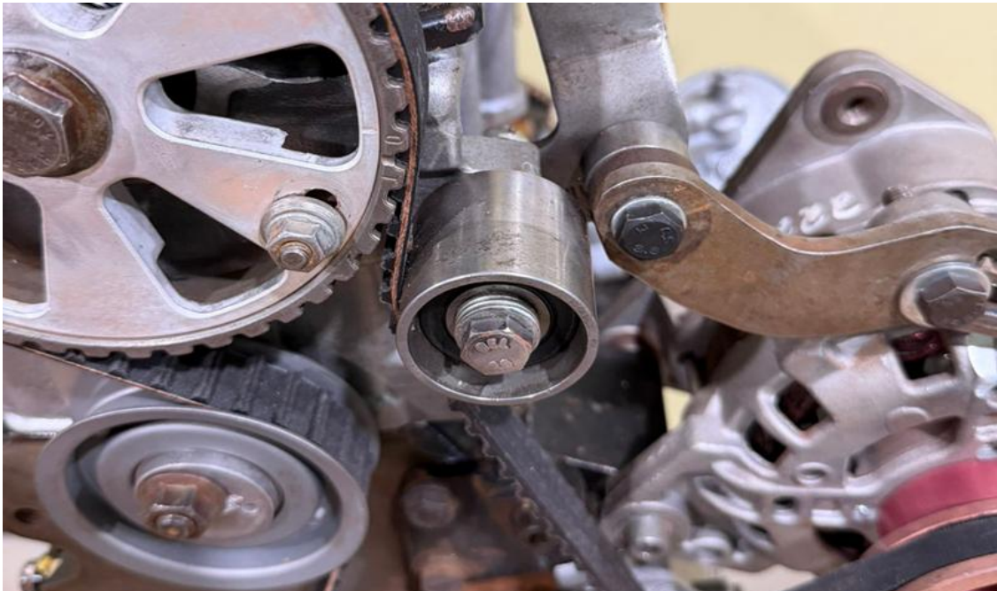
Imagem 11A – ilustração do rolamento de encosto da correia dentada.
