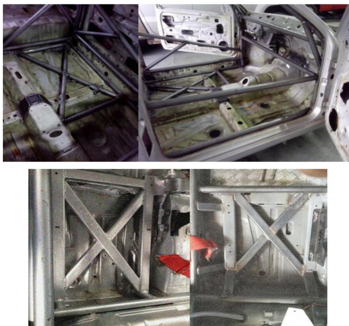
Imagem 8: Reforço "X" para fixação do suporte do banco
