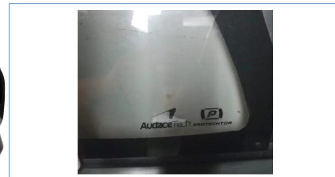
Policarbonatos Laterais e Traseiro (Gravados com AudaceTech e Protector) (Espessura 3 mm)
