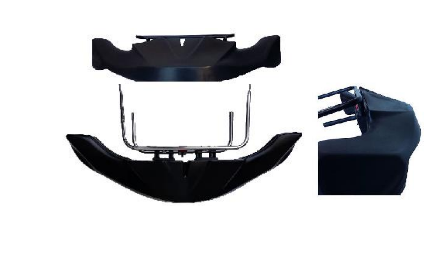
FOTO FRONTAL, SUPERIOR E LATERAL DO PAINEL DIANTEIRO (BICO) COM SUPORTES E FIXAÇÕES.
