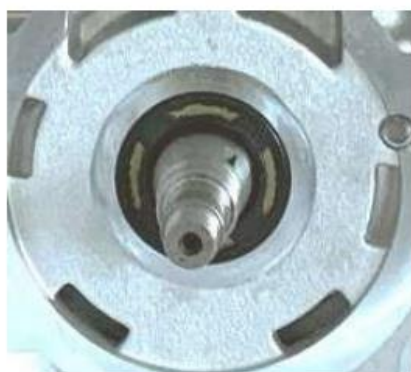
VISTA E DETALHES DO POSICIONAMENTO DOS RETENTORES DO VIRABREQUIM
