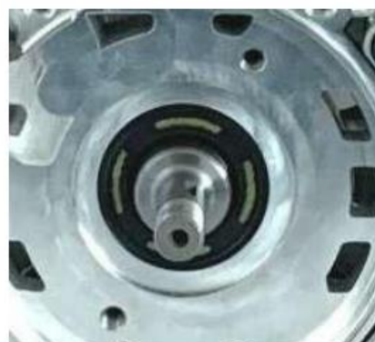
VISTA E DETALHES DO POSICIONAMENTO DOS RETENTORES DO VIRABREQUIM
