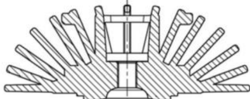
GABARITO PARA VERIFICAÇÃO DO PERFIL DA CÂMARA DE COMBUSTÃO
