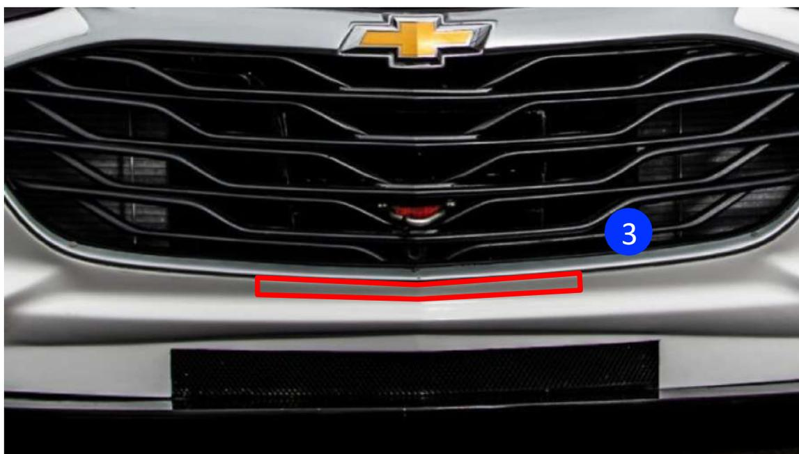
3. Permitido aumentar abertura da captação de ar conforme sugerido na imagem, seguindo o dimensional de 30 mm de altura por 400 mm comprimento.
