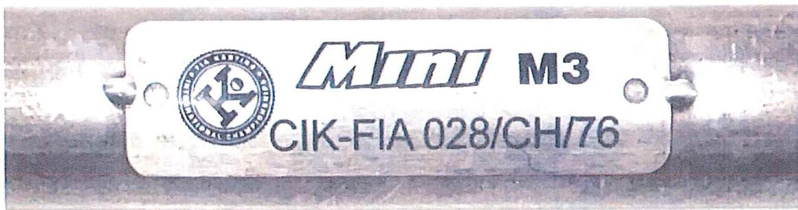
Le marquage indiqué sur le tube transversal arrière doit rester clairement visible en permanence. /
