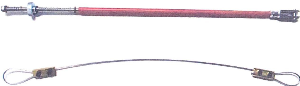
La commande de freinage doit être isolée du châssis et montrer la double commande. /
