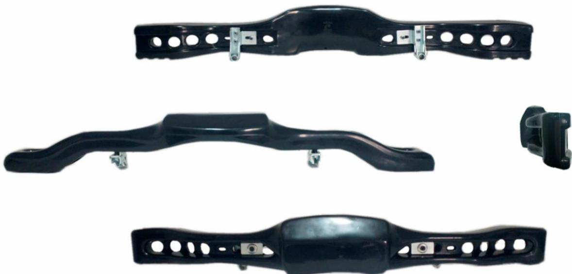
FOTO FRONTAL, SUPERIOR E LATERAL DO PÁRA-CHOQUES TRASEIRO COM SUPORTES E FIXAÇÕES.
