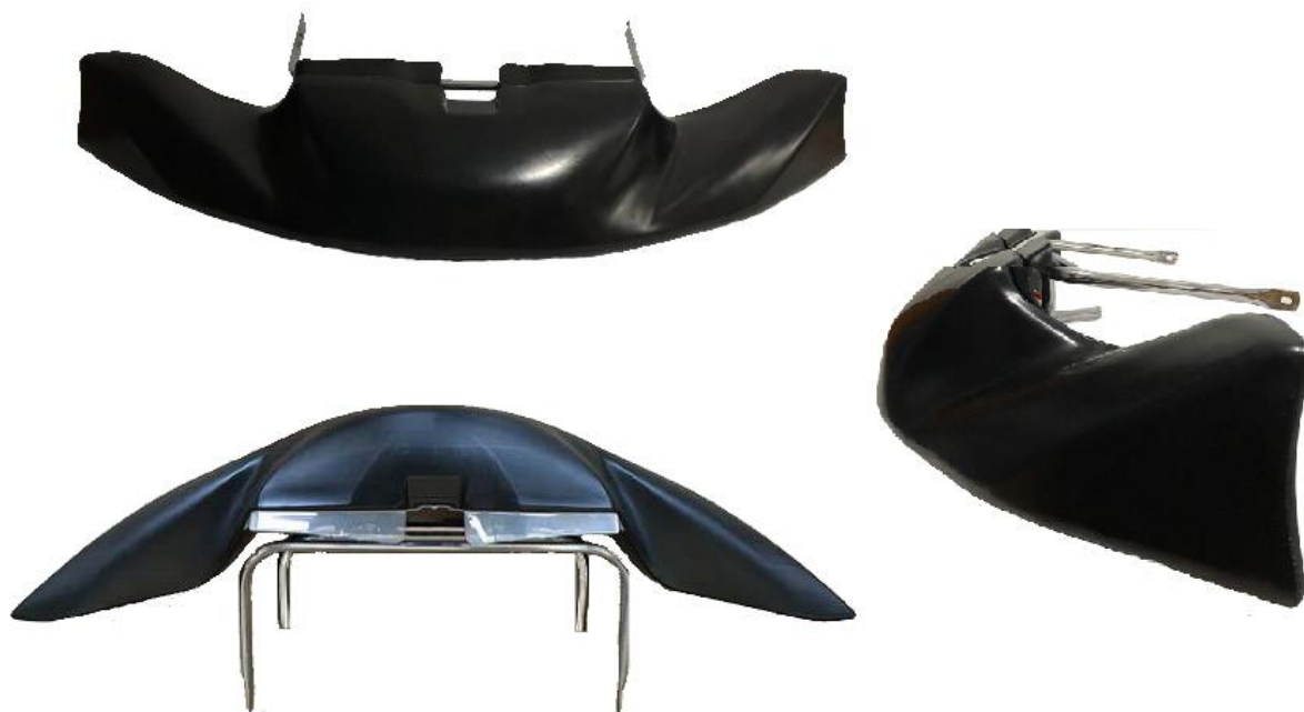
FOTO FRONTAL, SUPERIOR E LATERAL DO PAINEL DIANTEIRO (BICO) COM SUPORTES E FIXAÇÕES.
