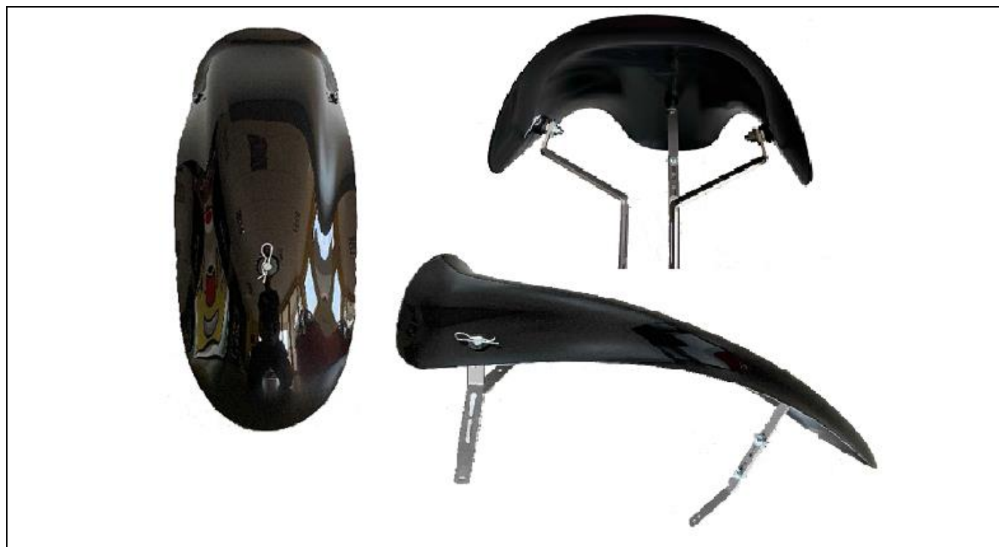
FOTO FRONTAL, SUPERIOR E LATERAL DO PAINEL SUPERIOR DIANTEIRO (GRAVATA) COM SUPORTES E FIXAÇÕES.
