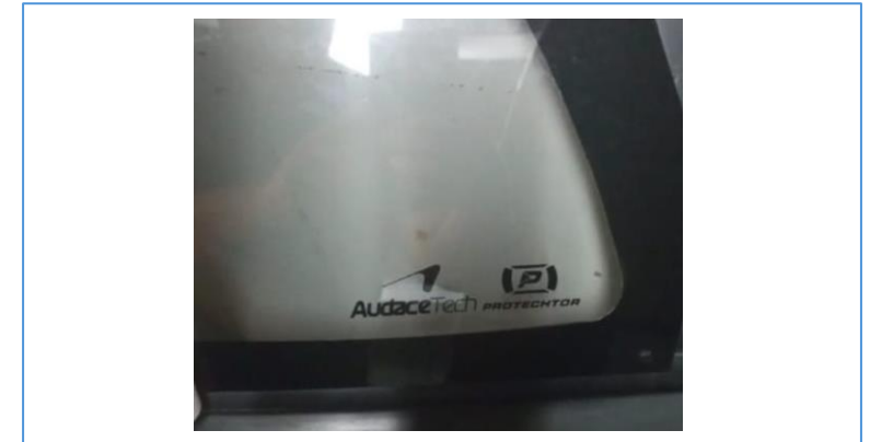
Policarbonatos Laterais e Traseiro (Gravados com AudaceTech e Protector) (Espessura 3 mm)
