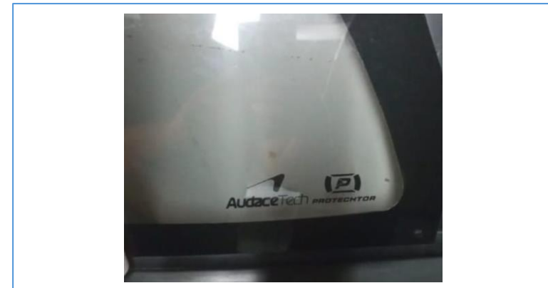
Policarbonatos Laterais e Traseiro (Gravados com AudaceTech e Protechtor) (Espessura 3 mm)
