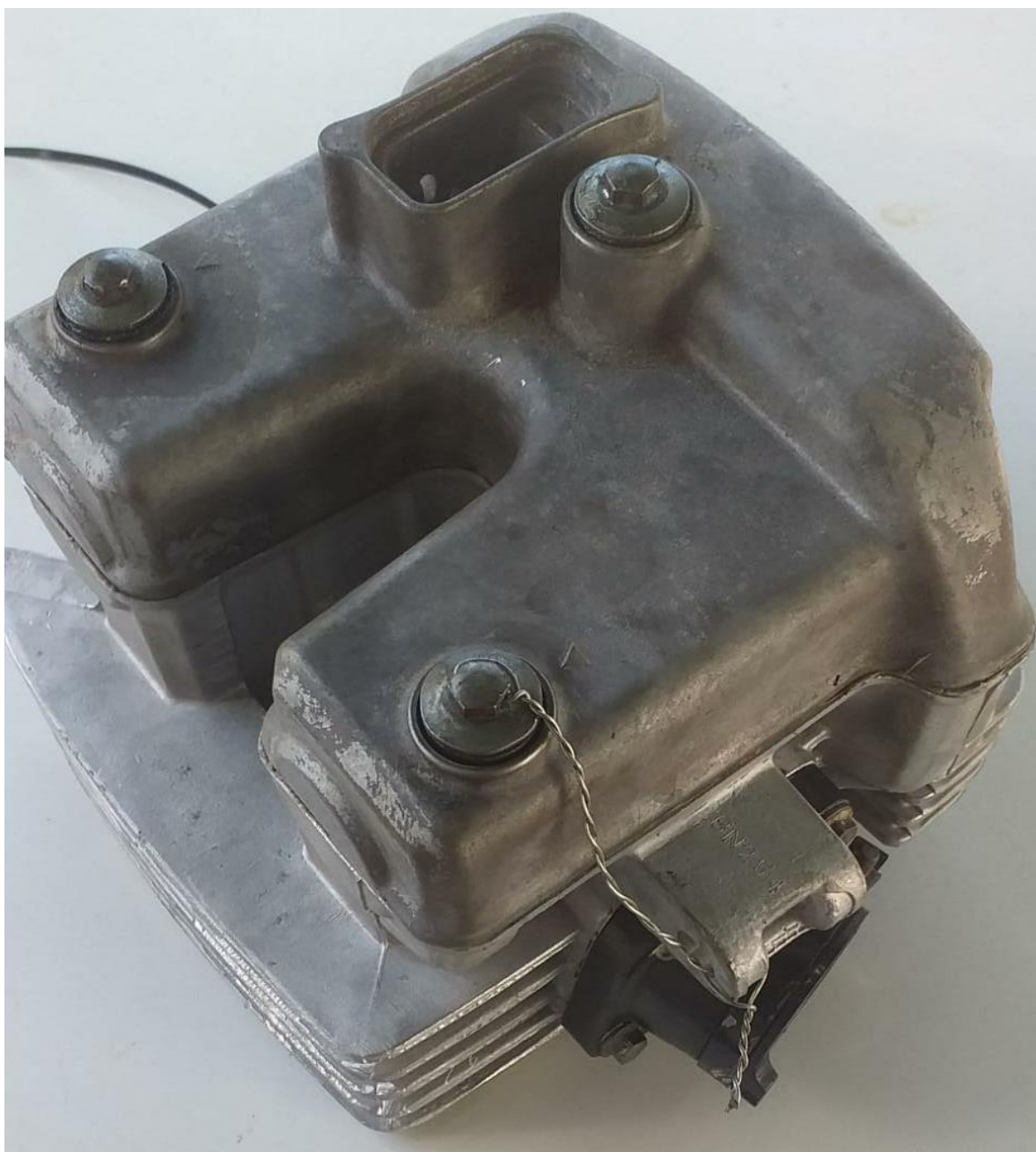
Imagem 1 – Detalhe furo passante no parafuso do cabeçote
