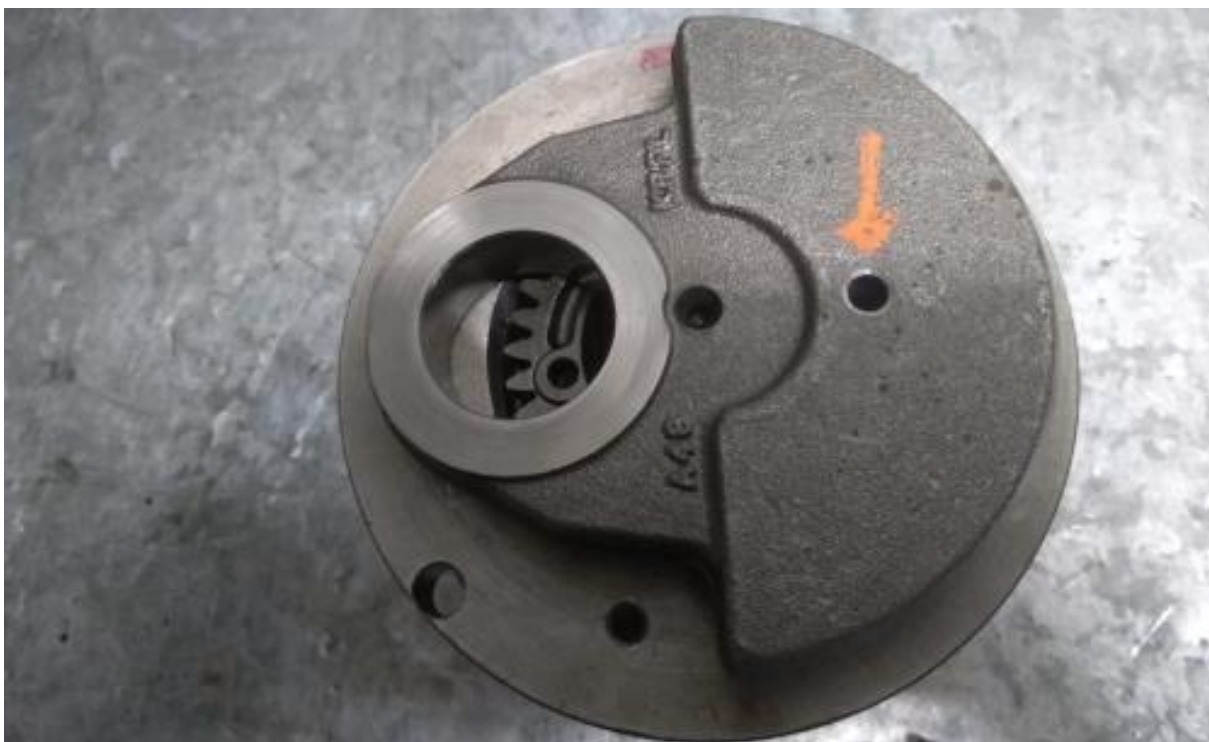
Imagem 3 – detalhe do furo na bolacha do virabrequim
