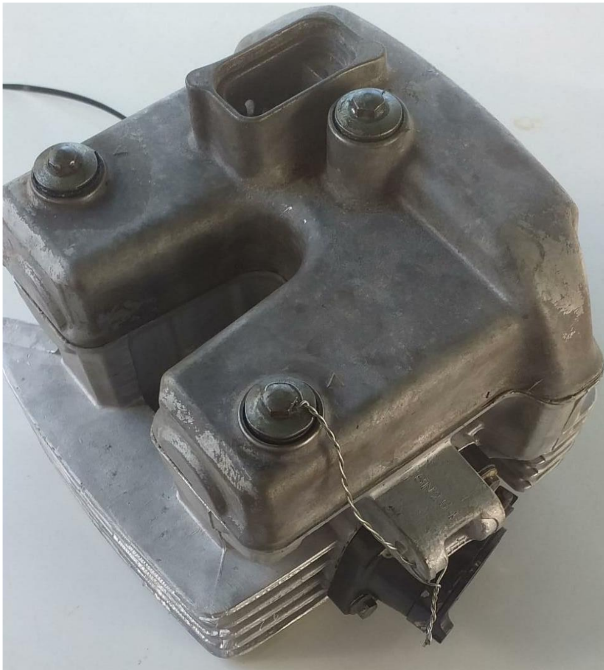
Imagem 1 – Detalhe furo passante no parafuso do cabeçote
