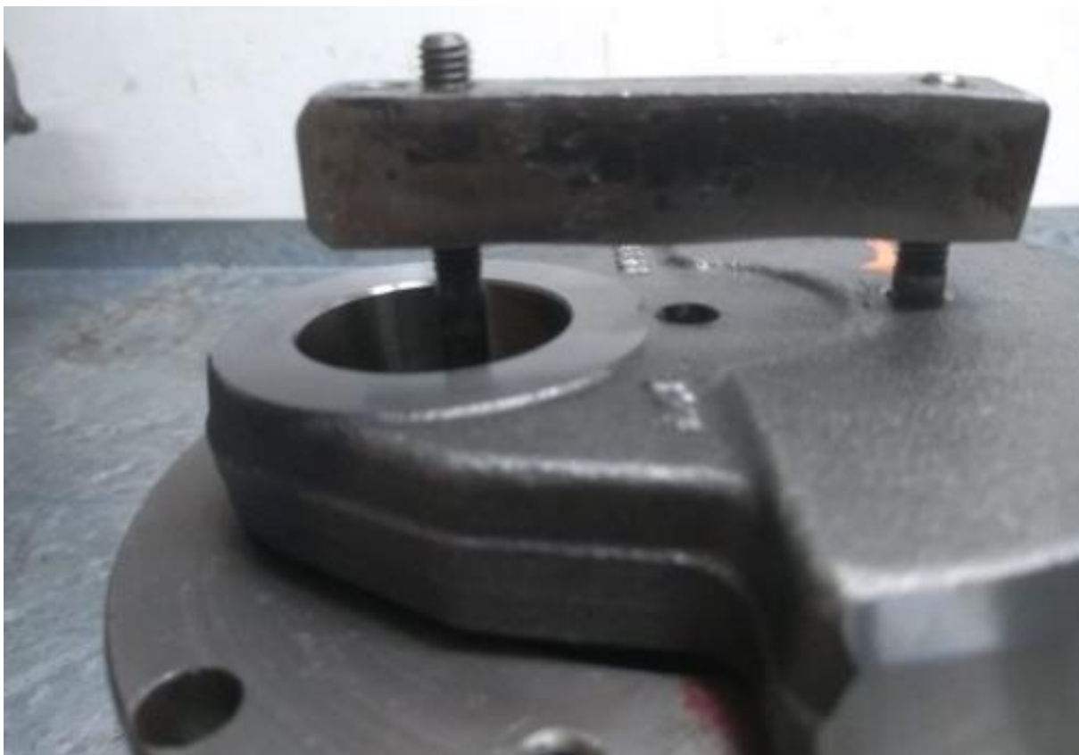
Imagem 5 – detalhe do saque da engrenagem com auxílio do furo e da ferramenta
