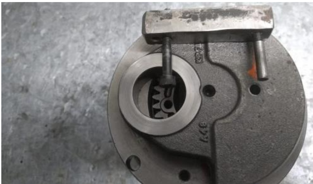
Imagem 4 – detalhe do furo na bolacha do virabrequim com ferramenta de saque
