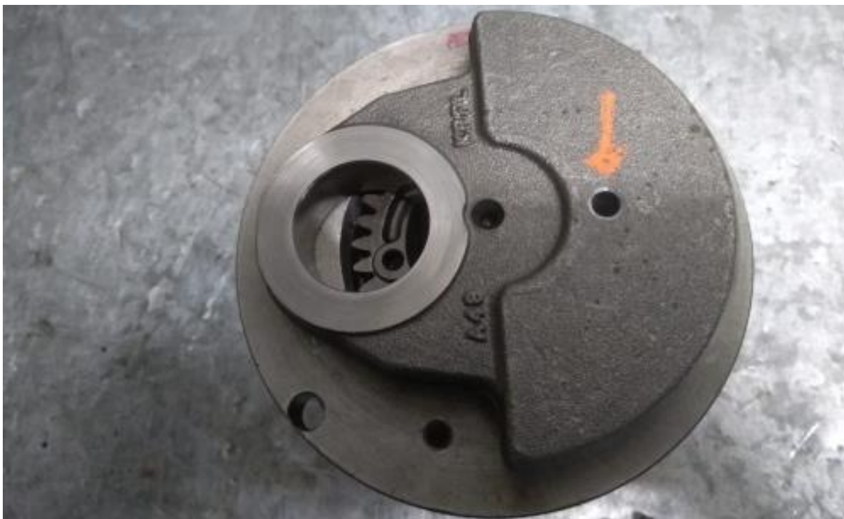
Imagem 3 – detalhe do furo na bolacha do virabrequim
